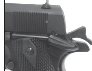
Fig. 8 Manuelle Sicherung in FEUER-Position
