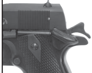
Fig. 1 Manuelle Sicherung in GESICHERT-Position
