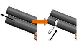
**FIG 4 INSERT FILL ADAPTOR**
