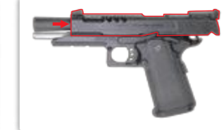
將滑套拉至後方使擊錘後定。
