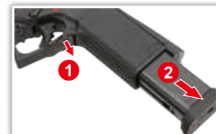
1. Abaisser l'arrêteur de chargeur. 2. Retirer le chargeur.
