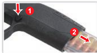
1. Jalar hacia abajo la palanca liberadora de cargador. 2. Remueva el cargador.
