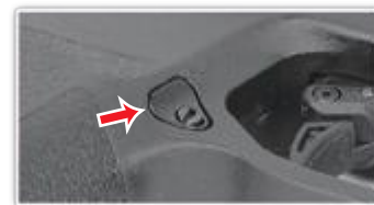
Gire al otro lado y encuentre el tornillo del liberador del cargador.
