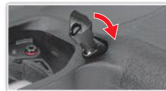
Cambie al otro lado de la pistola e instale el botón desde la parte superior.
