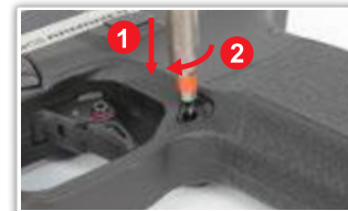
使用一字起子90度垂直下壓後順時針轉動螺絲鎖緊
