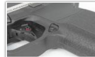
安裝完畢後測試彈匣釋放鈕動作是否正常
