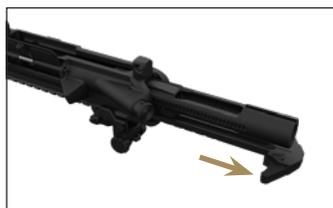
2. Verschluss aus dem Obergehäuse entnehmen
