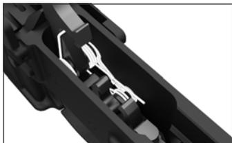
3. Drücken Sie die Schlaghammer und Abzug Haltestifte heraus um anschließend Hammer und Abzug zu entnehmen
