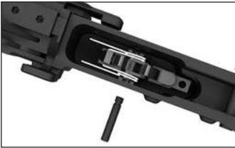
2. Richten Sie nun den Hammer im unteren Systemgehäuse aus. Achten Sie darauf, dass die Schenkel der Hammerfeder nach hinten zeigen und auf dem Abzug Haltestift liegen. Schieben Sie den Schlaghammer Haltestift, mit der Nut auf der rechten Seite, durch die Bohrung von Gehäuse und Hammer
