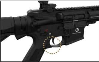
3. Sicherungshebel auf Position
