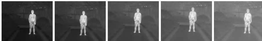
Afbeelding 3-3 Helderheid aanpassen in de wit-heetmodus
