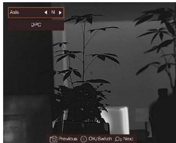
Afbeelding 3-4 Defecte pixel corrigeren
